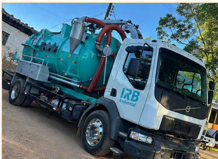
Caminhão hidro-jato combinado com sucção a vácuo utilizado nos serviços realizados no município.
